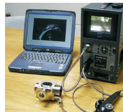
对所有用在洁净领域隔膜阀的阀体内表面焊缝进行内窥镜测试
