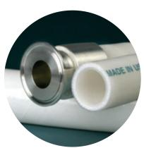
APSM四層心軸外包強化矽膠管因為其低揮發性物 質殘留與鉑金催化製程而製,非常適合應用於關鍵 製藥步驟,生醫,化妝品,食品業的應用。由於其 耐壓的特性,非常適合應用於排料製程。
